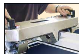
Guidage précis de la mèche – poussée pneumatique
